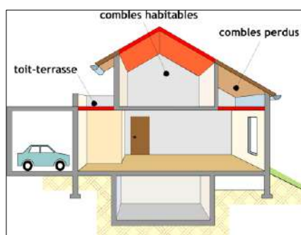
Schéma montrant les différents planchers hauts que l'on peut retrouver dans les logements
